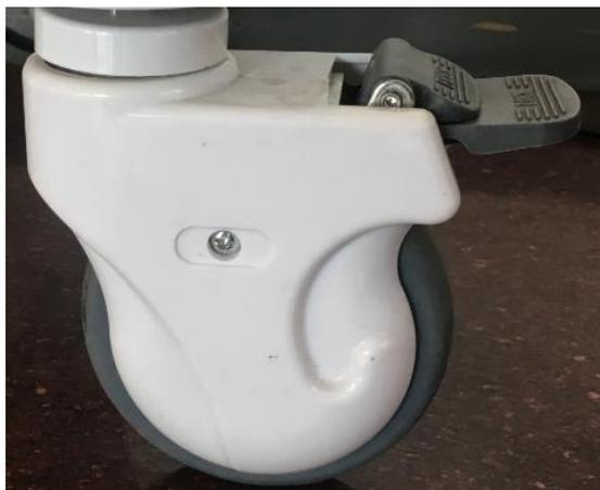
En la siguiente imagen pose puede apreciar el bloqueo activado:
